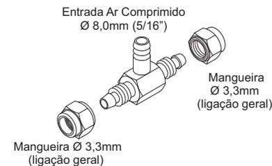
Obs: Utilizadas na "DERIVAÇÃO" da mangueira do compressor para alimentar Caixa de Comando
