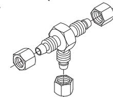
**CONEXÃO EM "T" COM REDUÇÃO (COM ROSCA)**
