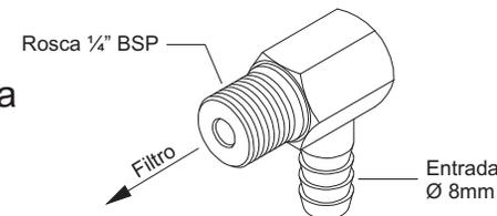
**CONEXÃO PARA FILTRO DE AR EM "L" (90° COM PORCA)**
